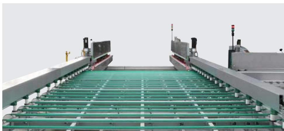
*Im Transfer wird die Glasscheibe von der oberen Ebene der 1. Titan-Maschine über ein Druckluftsystem mit Rädern auf die Transportriemen des Transfers abgelegt. Dadurch wird jede Art von Beschädigung auf der Glasscheibe verhindert.*
