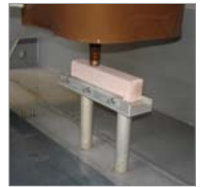
Dressing of drilling bit Ravvivatura foretto - Dressage foret - Aufrauung der Bohrspitze - Avivador broca taladradora
