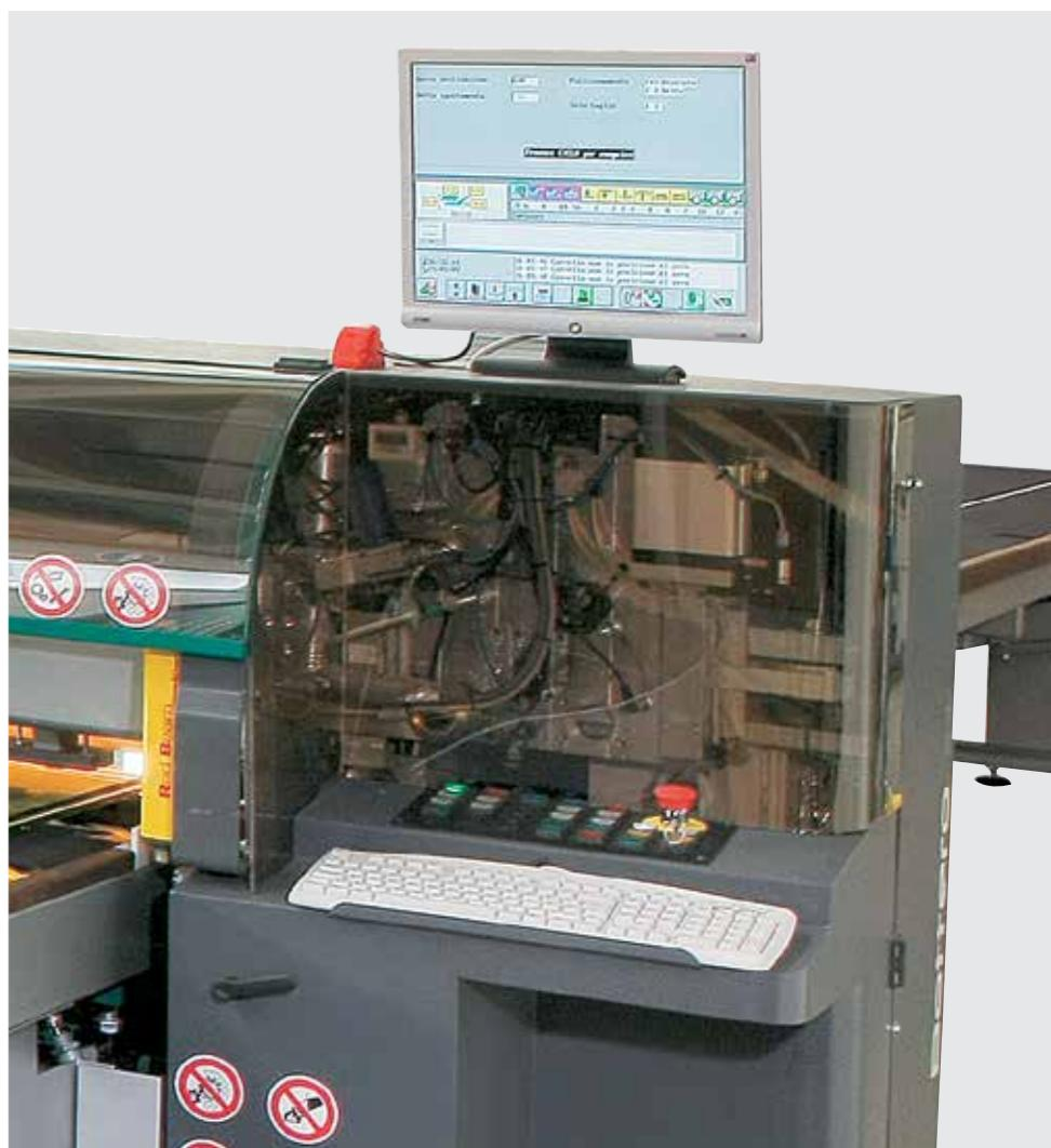
L'interface de l'opérateur permet une saisie facile des données de production et au moyen de la fonction de «Superviseur» il affiche l'état machine et le cycle d'usinage en cours. Tous les paramètres de la machine sont chargés automatiquement par le logiciel en fonction du type de verre relevé, en laissant à l'opérateur l'unique fonction d'exécuter le cycle. La fonction du superviseur indique à l'opérateur la séquence des découpes en accélérant toutes les opérations de manutention.
